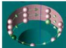
取样方法示例: 触发测量
