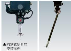
▲触发式测头的安装示例
